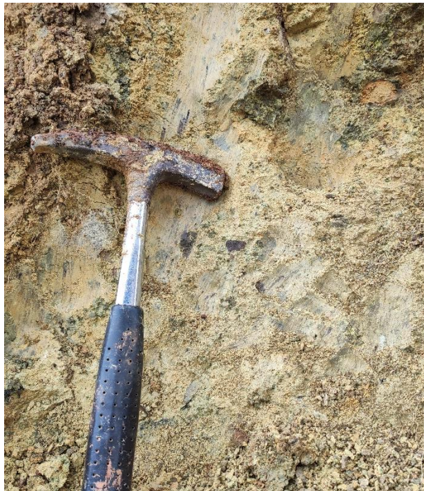
Imagem 3. Detalhe do solo argiloso no afloramento da Rodovia Santos Dummont. Notar a coloração avermelhada do material que cobre a ponta do martelo, resultado da escavação da camada superior, mais tingida do afloramento.
